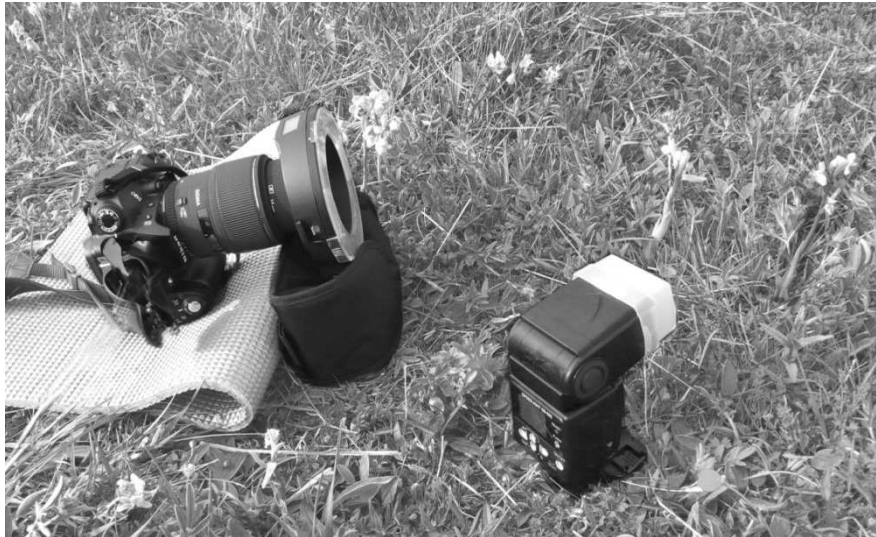
Flash anular, en la cámara, con Flash esclavo, externo, como luz de relleno
